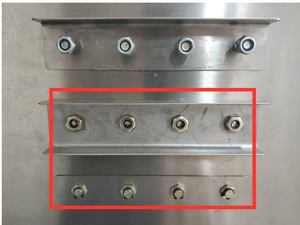
图 Z3-10 面板拆装及内外卡簧保险
